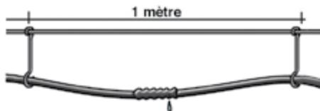
Sur les parcelles en pente ou si le goutte à goutte n'est pas bien tendu (attention avec la chaleur, il s'assouplit ! ), on positionnera le clip de suspension de façon à stopper la goutte pour ne pas qu'elle coule le long du tube.
