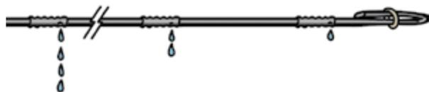
Si la rampe dépasse la longueur maximale, les goutteurs en fin de rampe auront un débit inférieur aux premiers. **Pour une irrigation homogène sur le rang, cette variation doit être inférieure à 10%.**
