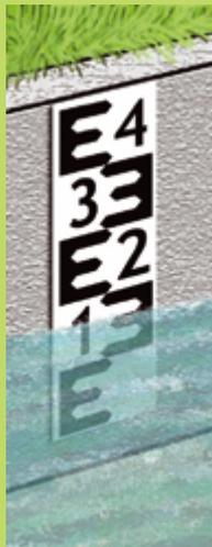
C'est une règle verticale permettant de repérer le niveau du fil d'eau au cm près. Elle est constituée d'une tôle émaillée graduée en cm et lisible de loin.
